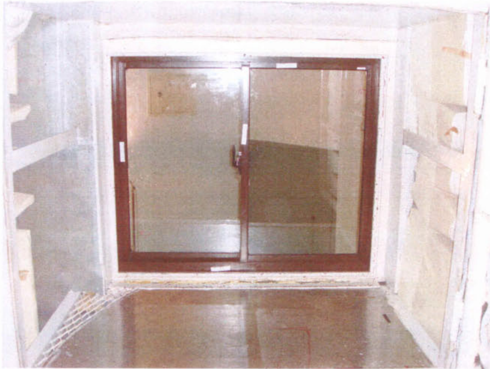
圖 1 試樣佈置圖 (無響室)
